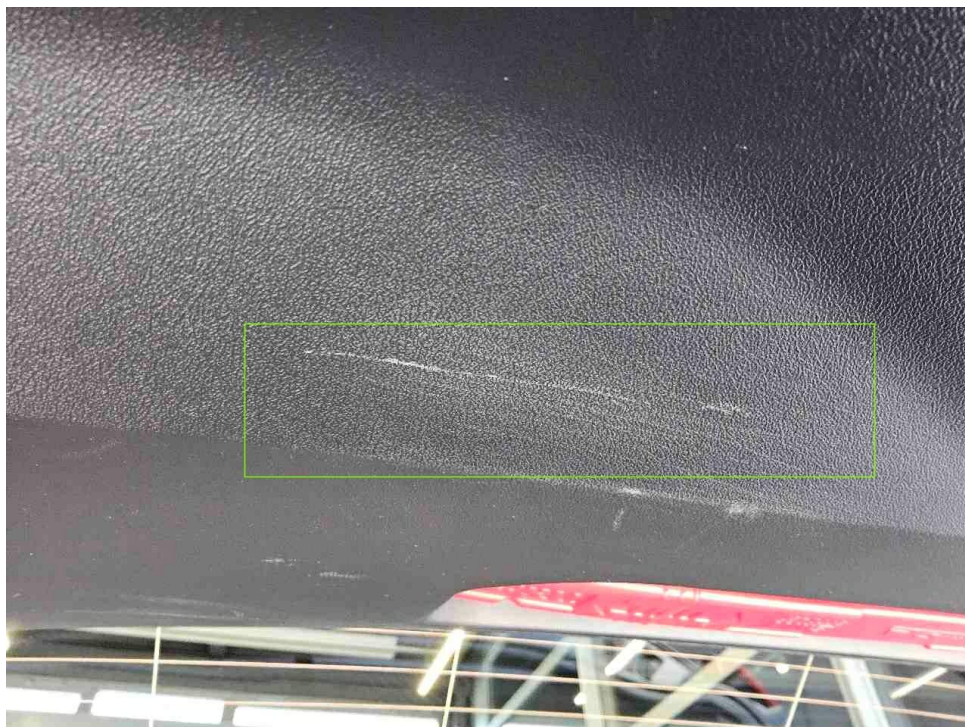
Bild 14 : Heckklappenverkleidung leicht verkratzt
